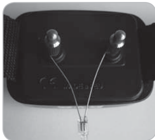
Проверка разряда с использованием тестовой лампы
